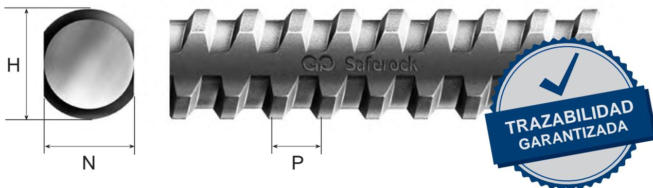
Los Pernos Saferock® para refuerzo de rocas, son productos de una sección transversal resistente, levemente ovalada con resaltes en forma de un hilo helicoidal izquierdo de gran paso. El suministro se hace en barras rectas, en su estado de laminación en caliente y sin tratamientos posteriores.
